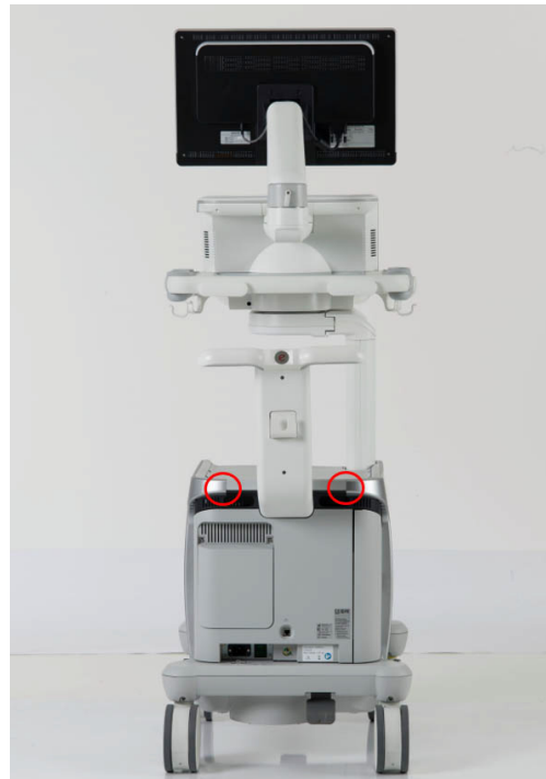
Fig. 2-1: Position de l'antenne sans fil sur les appareils de MyLab 9 Family
