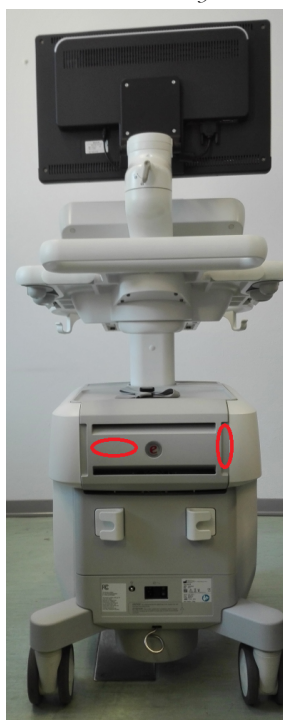
Fig. 2-1: Posizione dell'antenna wireless su MyLabX75 Family e MyLab XPro75
